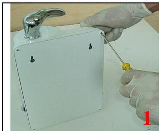
1 Inicie o processo desparafusando a tampa traseira do filtro. Solte os quatro parafusos, utilizando a chave de fenda número 1/8 / 4.
