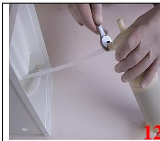
12 Agora, proceda com a instalação do novo elemento filtrante. Com o auxílio da chave de boca 5/8, aperte levemente a porca da mangueira no bico lateral do elemento.
