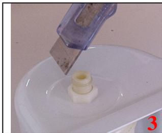
3 Em seguida, remova o anel de vedação cortando o mesmo com o auxílio de um estilete.
