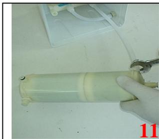
11 Após retirar o elemento filtrante do gabinete, solte a mangueira, com o auxílio da chave de boca número 5/8, soltando o elemento filtrante.
